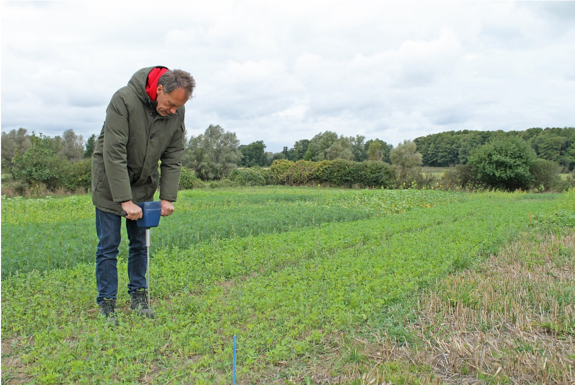
Bild 1: Der Leiter der Versuchsstation Berge Dr. Andreas Muskolus misst mit einem Bodenforschungslogger die Bodenfeuchtigkeit. Die wöchentliche Messung soll helfen zu klären, welche Zwischenfrucht am meisten Wasser verbraucht.
