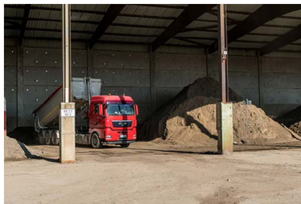
Abb. 3-2: Transport-LKW kippt Bodenmaterial für das Recycling in die Lagerhalle (Quelle: Matthäi Bauunternehmen GmbH & Co.KG)
