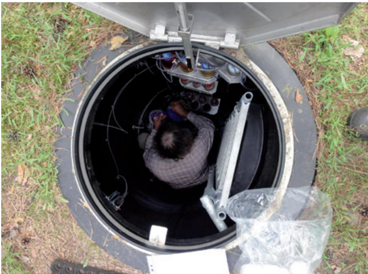
Bodenschacht mit Saugkerzen zur Sickerwasser-Probenahme an Dauerbeobachtungsflächen Level II (Foto: F. BECKER)
