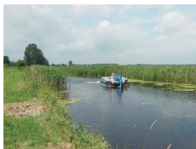
Abb. 11: Maschinelle Krautung mit Mähboot
