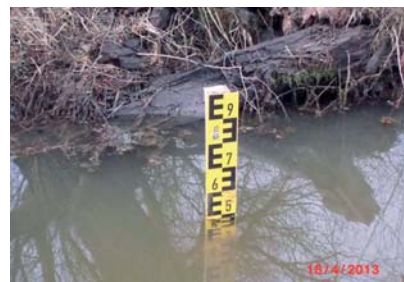
Abb. 42: Hilfspegel zur Kontrolle des tolerierbaren Maximalstaus
