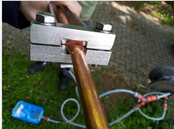
Abb. 1 verschlossene Klemme am Kupferrohr zum luftdichten verschließen der Grundwasserprobe für die Edelgasanalytik
