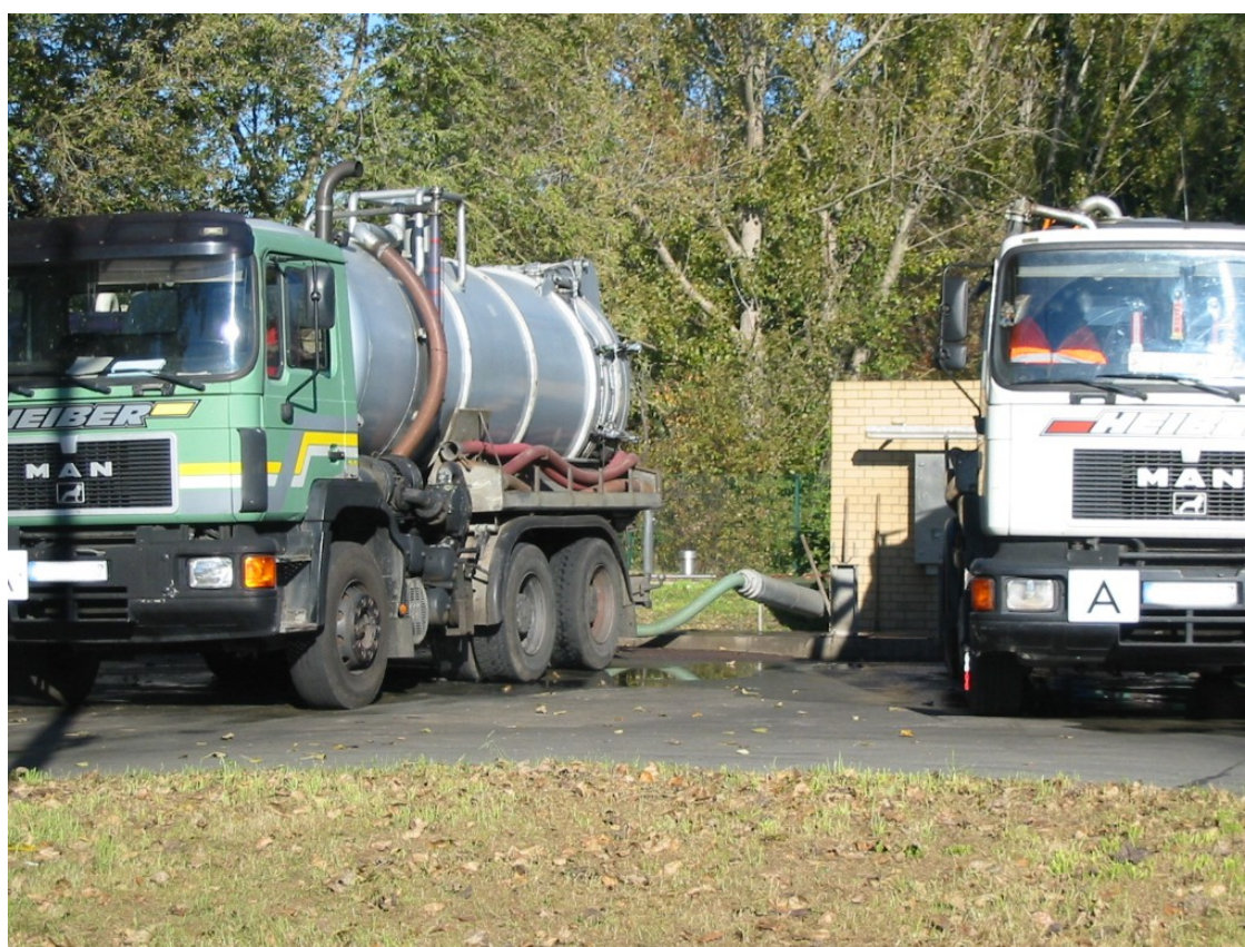
Abb. 10: Fahrzeuge zur Abfuhr des Abwassers aus abflusslosen Sammelgruben und des Klärschlammes aus Kleinkläranlagen
