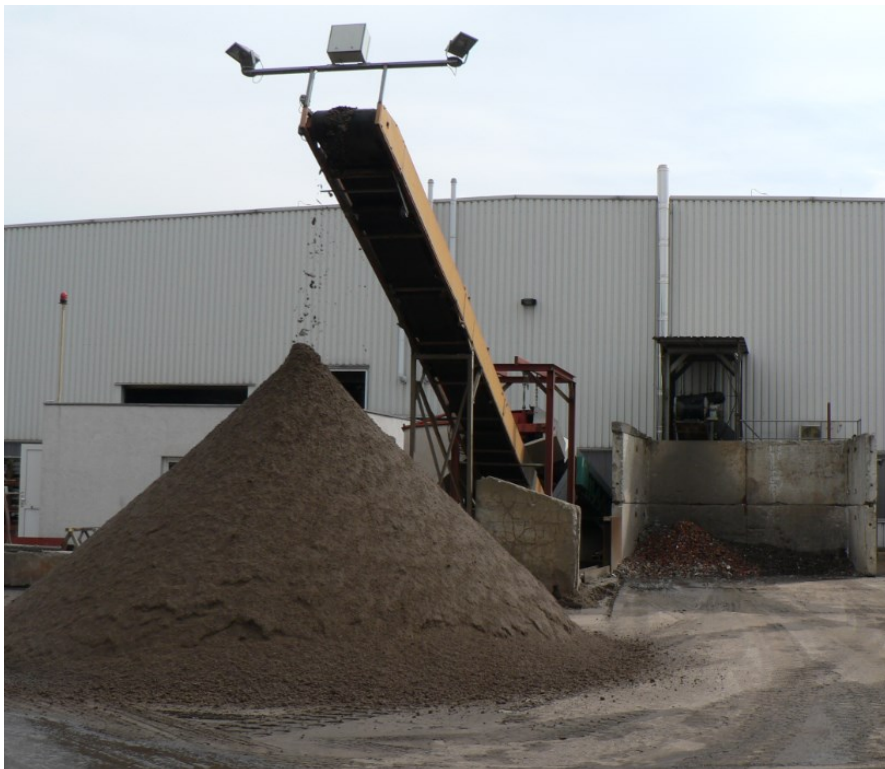
Betrieb einer Bodenwaschanlage
