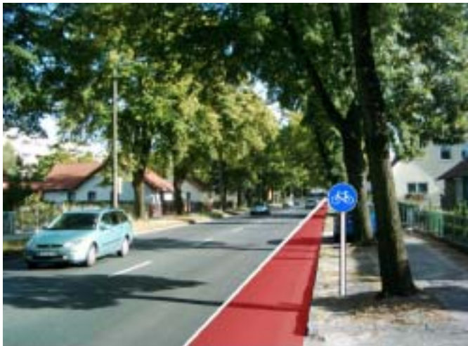
Abbildung 46: Mögliche Abmarkierung von Radfahrstreifen in der Kopernikusstraße
